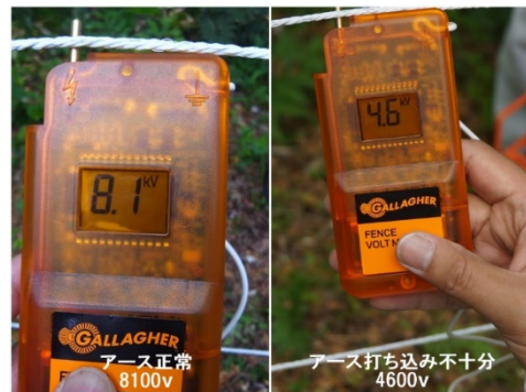
写真3 アース不足では電圧は上がらない
