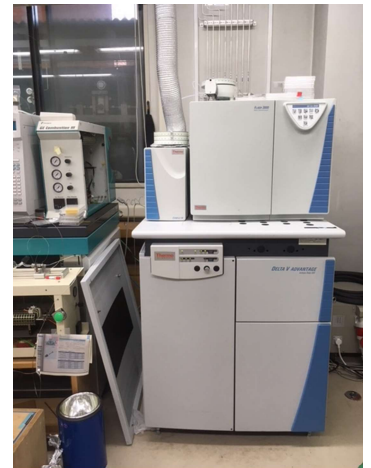
写真③ 元素分析計を接続した同位体比質量分析計（EA-IRMS）
