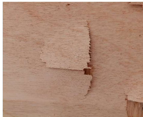
写真4：着弾の衝撃で割れたコンパネ。ゴム弾は貫通していない。
