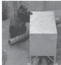
北海道の動物園にご協力いただき、強度試験を行いました。また野外に設置して、野生のヒグマで試験を行いました。いずれにおいても破損、転倒されず、強度等については、実証済みです。
