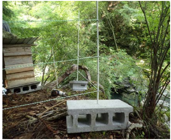
写真2：コンクリートブロックを用いて支柱を固定した（地点1）。
